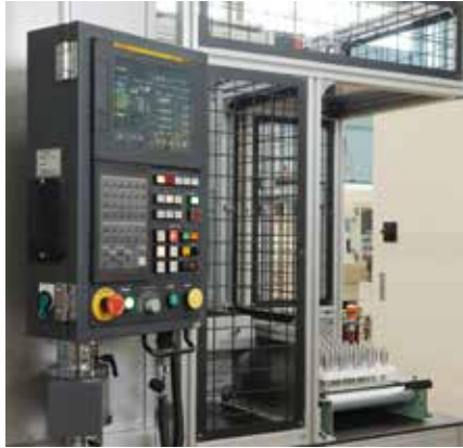
機械側の操作盤でローダーもコントロール
